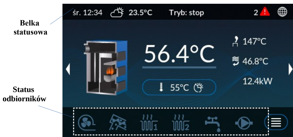
Ilustracja 16: Ekran główny, ekran kotła C.O.
